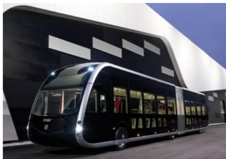
L'Irizar ie tram est un autobus 100 % électrique zéro émission avec les attributs esthétiques propres du tramway, qui combine la grande capacité, la facilité d'accès et la circulation intérieure d'un tramway avec la flexibilité d'un autobus urbain. Ce modèle est disponible en différentes versions, de 12 m et 18 m, articulé et avec une capacité maximale de 155 personnes.
